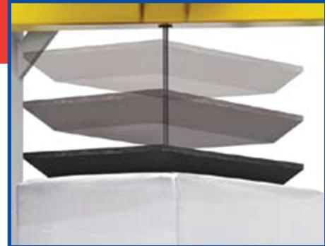
**中文** 封膜机构是伸缩式可自动适应托盘尺寸变化
