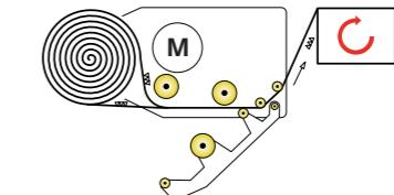
中文\_动力预拉膜架带3个驱动轮,电子式控制,固定预拉比: 150-200-250%.
